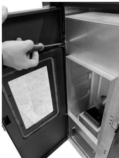
Fig. 33 - Retrait des vis
