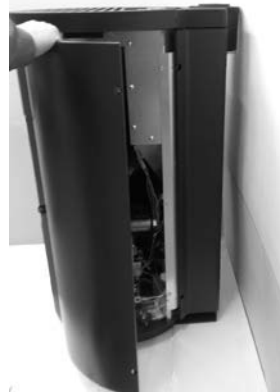
Fig. 55 - Décrocher les flancs
