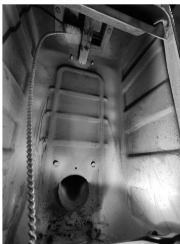
Fig. 79 - Nettoyer avec un goupillon.
