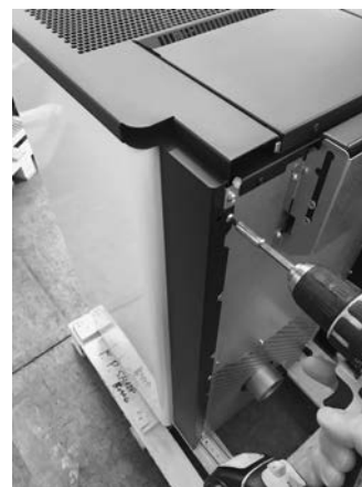
Fig. 47 - Fixer le flanc complet
