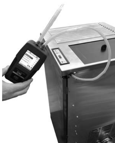
Fig. 70 - Connexion du pressostat numérique
