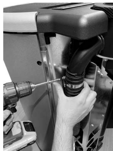
Fig. 63 - Extraire le tuyau flexible
