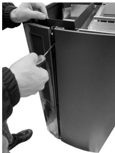
Fig. 48 - Retirer les vis
