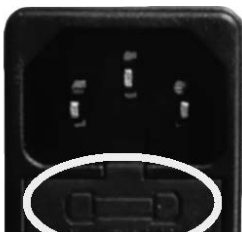
Fig. 82 - Hublot avec les fusibles à enlever
