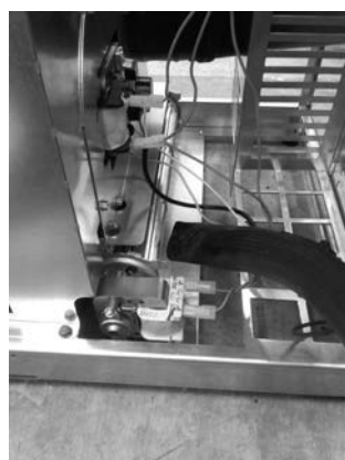
Fig. 81 - Nettoyage de le ventilateur ambiant
