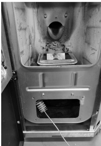
Fig. 77 - Nettoyer avec un goupillon.
